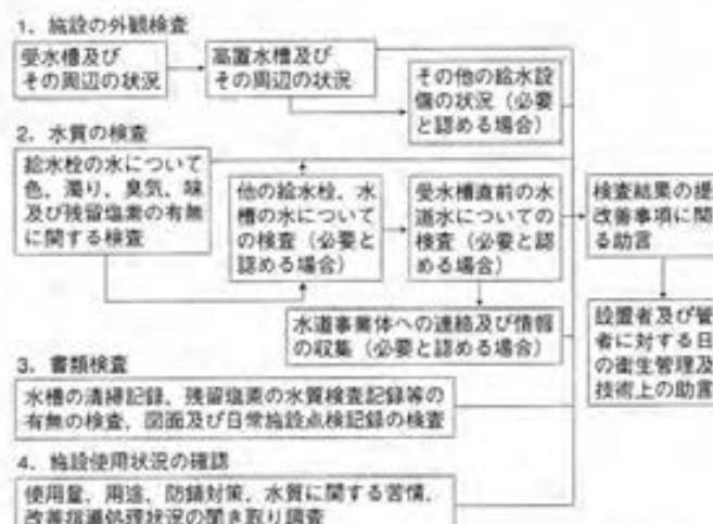
図-1 簡易専用水道の検査フロー
