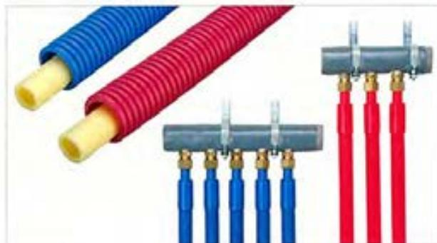
速やかな設備配管のために開発されたクボタフレキパス。枝管はヘッダーを通して蝶足状に分岐配管されるため、接合工数が大幅に低減。継手部からおこる漏水の確率も格段に低く、維持管理もラクに行えます。
