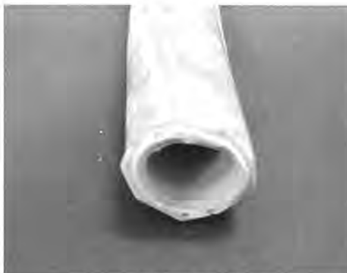
図-4 更生後の鉛給水管
