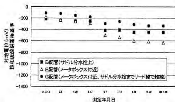
図-10 陽極設置位置の違いによるサドル付分水栓とステンレス給水管の対地電位変化（第二種改良土）
