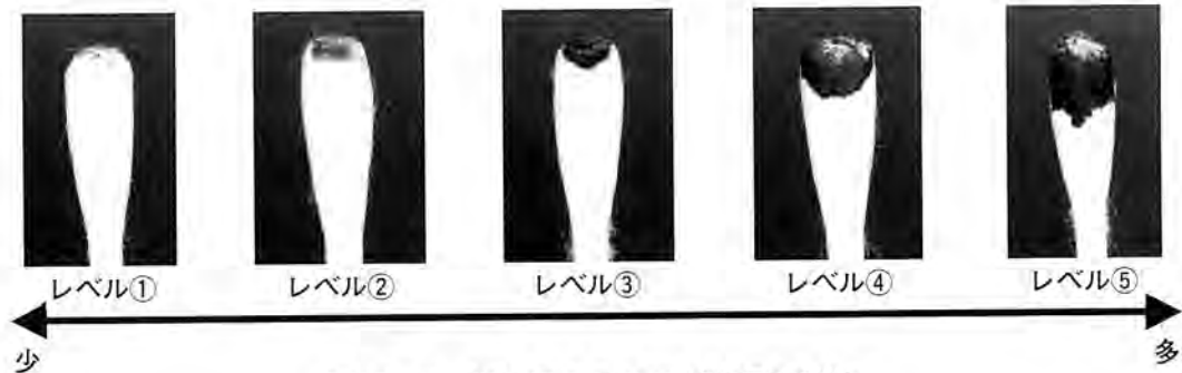
写真-2 綿棒によるCB析出量の測定
