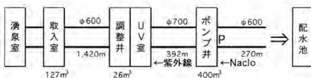
図-1 蟹沢浄水場のフロー
