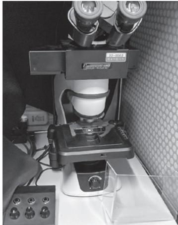
図6 蛍光物質のカウントに用いた顕微鏡と蛍光光源
