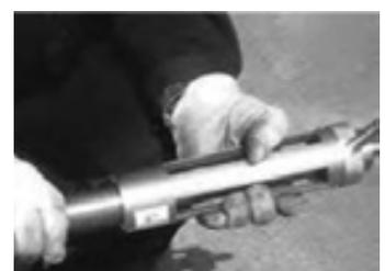
なお、写真で示す穿孔機は、一般的に用いられている電動穿孔機でなく、穿孔の過程を自らの手で感じることができ、(公財)給水工事技術振興財団が行っている「給水装置工事配管技能検定会」の穿孔にも使用されている手動穿孔機とした。
