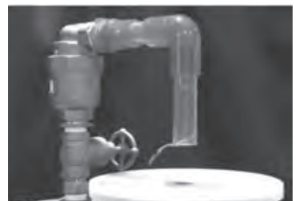
(c) 吸排気弁口径 25mm (流量 150mL/min)
