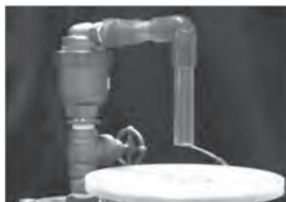
(b) 吸排気弁口径 25 × 20mm (流量 200mL/min)
