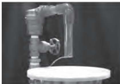
(a) 吸排気弁口径 20mm (流量 150mL/min)
