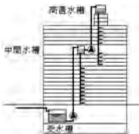
図 10 多段高置水槽方式
