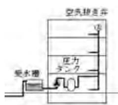
図 14 圧力水槽方式
