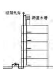
図 5 増圧高置水槽方式
