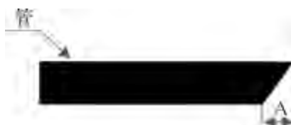
図3 管切断作業時の斜め切断状態
