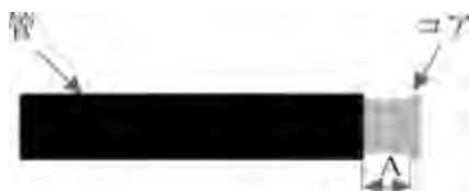
図4 コアの打ち込み状態
