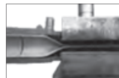
EF接合部の試験例 圧縮はく離試験の実施状況
