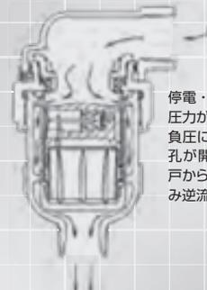
停電・断水などで給水圧力が低下、立管内が負圧になると、大空気孔が開き多量吸気。住戸から立管への吸い込み逆流を抑制します。
