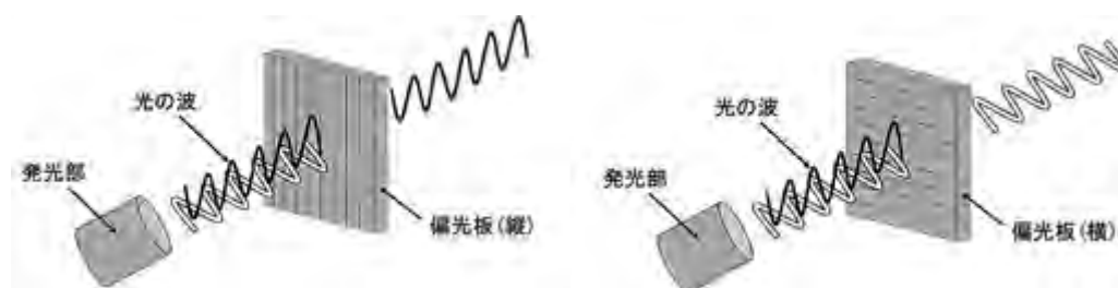
図3 偏光板センサの原理
