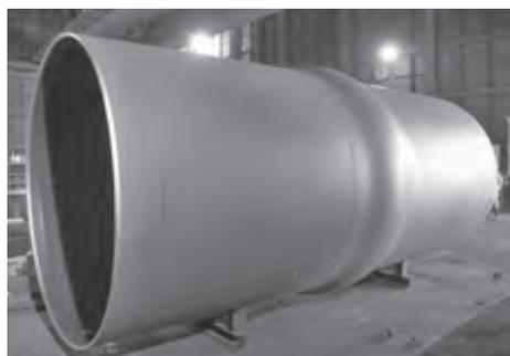
Photo. 3 断層用鋼管（口径2,400mm）
