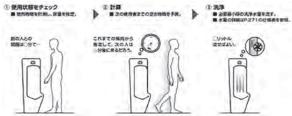
図 節水制御のメカニズム
