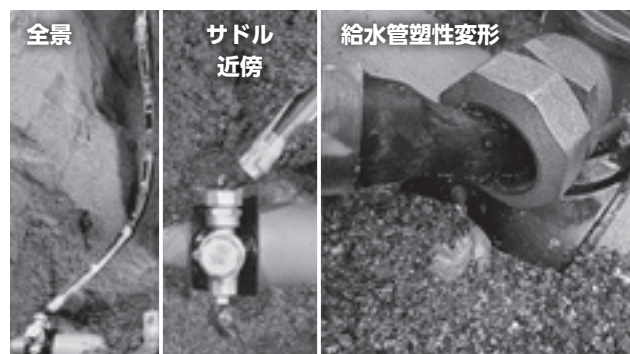
写真 2 従来型給水分岐部試験後状況
