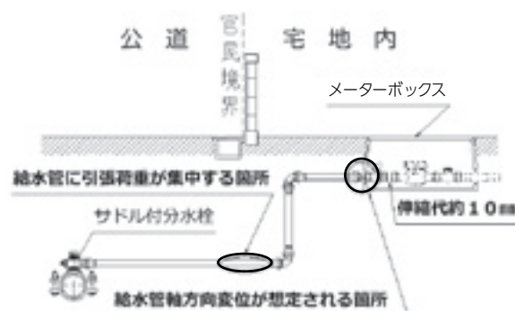
図8 給水管変位想定箇所
