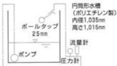
図-1 循環方式におけるボールタップからの発散実験装置
