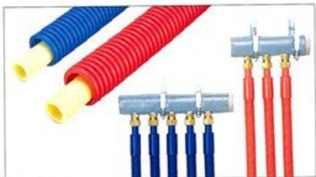
速やかな設備配管のために開発されたクボタフレキパス。枝管はヘッダーを介して鎖定状態に分岐配管されるため、接合工数が大幅に低減。継手部からおこる漏水の確率も格段に低く、維持管理もラクに行えます。
