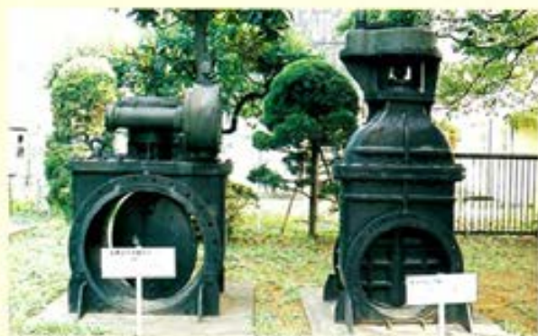
● バタフライ弁(左)と仕切り弁(右)の屋外展示
