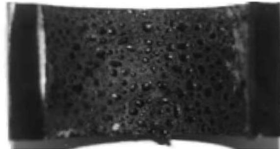
図6 LDPE管の水泡剥離の様子
