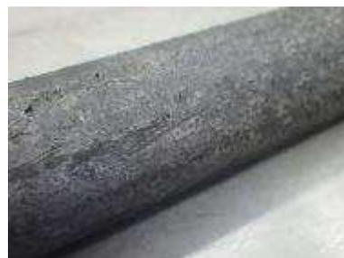
図 10 評価供試体に観察された表面ガラツキ (No. 11)
