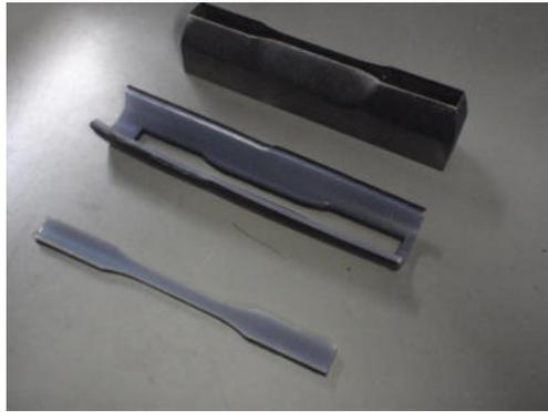
写真 3.2 原管および試験片
