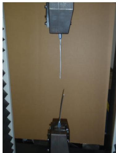
写真 3.6 試験状況（破断）
