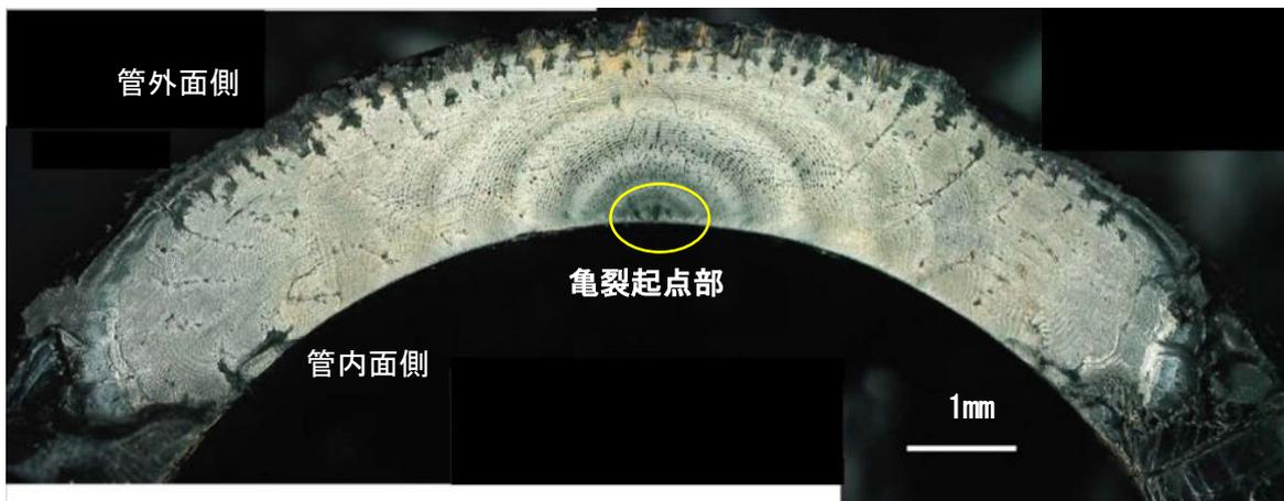
図 16 管周方向亀裂成長破面 (No. 12)
