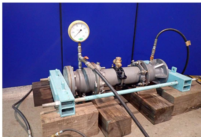
図 7-24 分水栓ねじ込み部回転時の水圧試験装置
