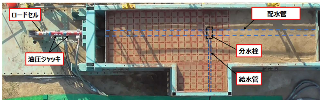
図 6-1 耐震試験装置
