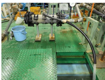
図 7-27 耐震試験後の供試品 1
