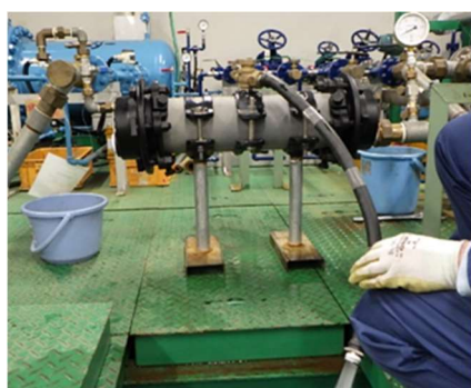
図 7-35 耐震試験後の供試品 1
