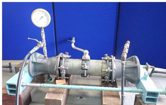
図 7-22 試験画像：SUS 可とう継手+SUS 波状管配管
