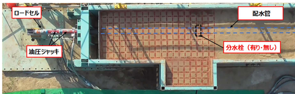
図 8-1 耐震試験装置
